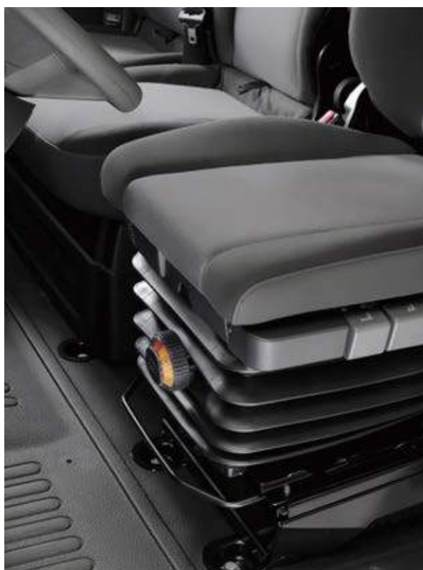
ASIENTO CON SUSPENSIÓN ajustable en altura y profundidad, con reposacabezas regulable, reposabrazos central y soporte lumbar.
