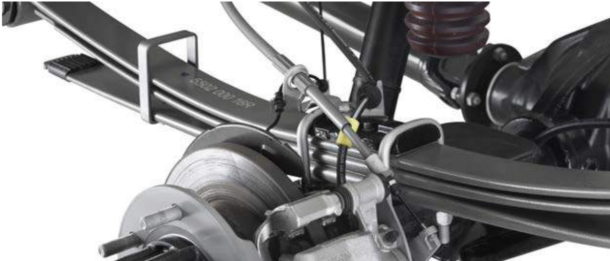
SUSPENSIONES PARABÓLICAS 2 o 3 ballestas.
