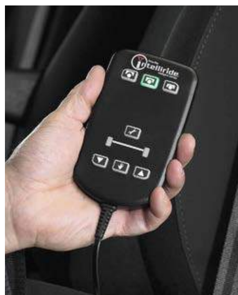
MANDO A DISTANCIA DE AJUSTE DE LA SUSPENSIÓN NEUMÁTICA para ajustar la altura de carga y facilitar el acceso a la zona de carga.
