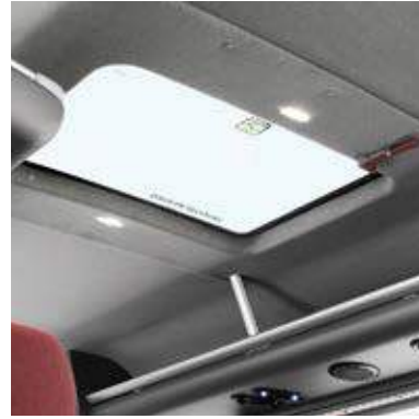
SALIDA DE EMERGENCIA retroiluminada debajo del techo.
