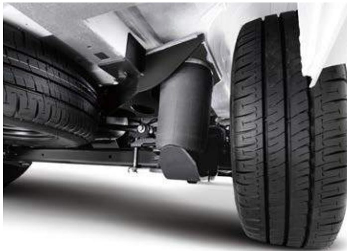
SUSPENSIÓN NEUMÁTICA para estabilizar el vehículo al pasar por obstáculos, independientemente del nivel de carga.
