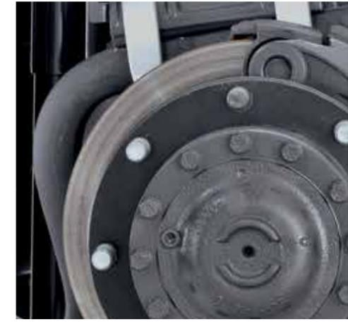
**FRENOS DE DISCO** permiten una deceleración de 7 m/s<sup>2</sup> en caso de frenado de emergencia (la normativa exige 4,5 m/s<sup>2</sup>).
