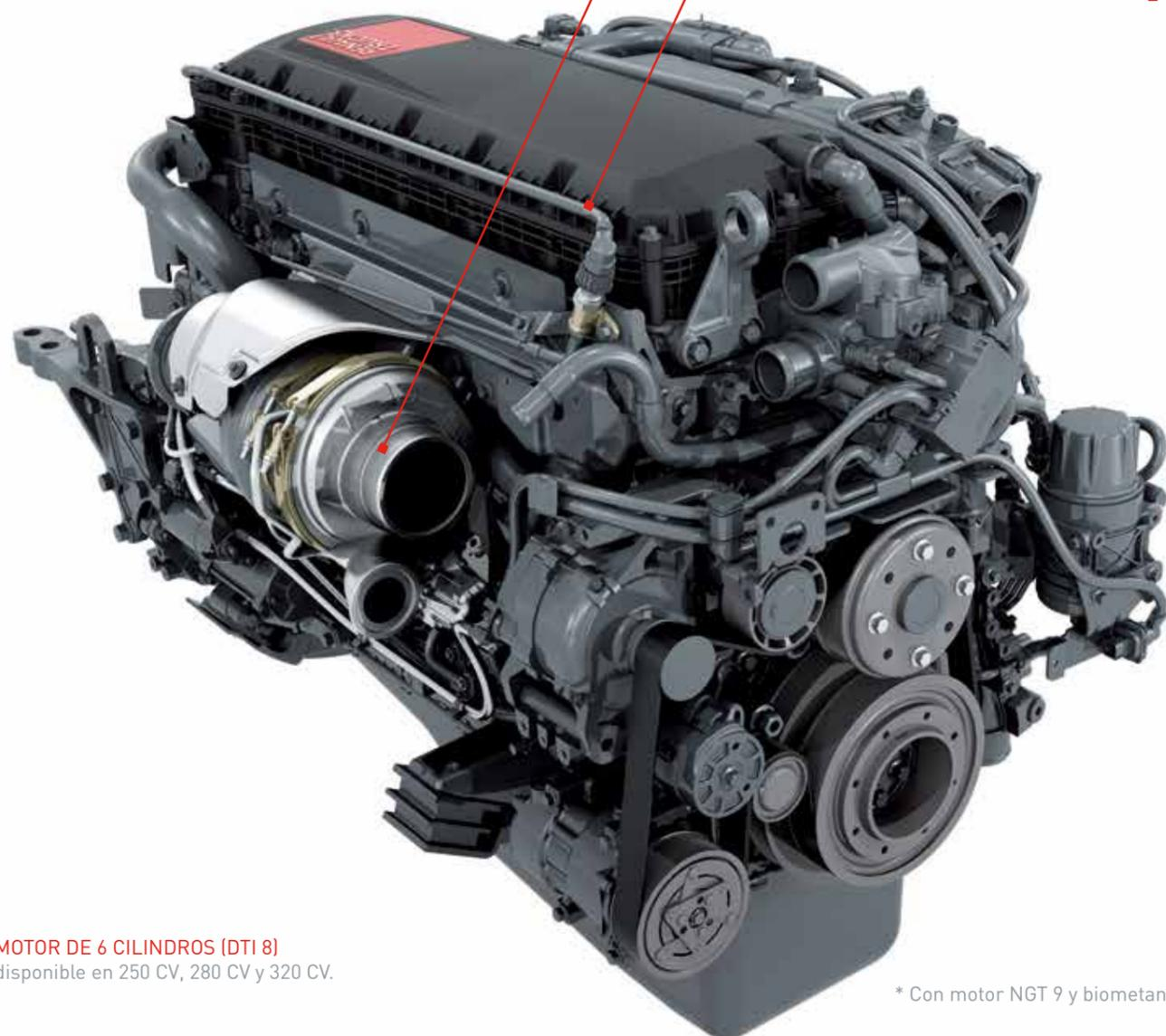
**MOTOR DE 6 CILINDROS (DTI 8)**
