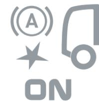
**FRENADO DE EMERGENCIA AUTOMÁTICO** avisa de una posible colisión y después frena y detiene totalmente el vehículo sin que intervenga el conductor.
